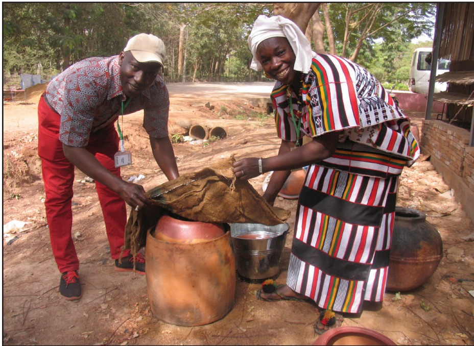
Djiguiba Boureima (gauche) et Kadidia Nienta (Droite) assemblent un pot de refroidissement par évaporation en argile à Samanko, Mali; Crédit photo: Ba Germain Diarra
